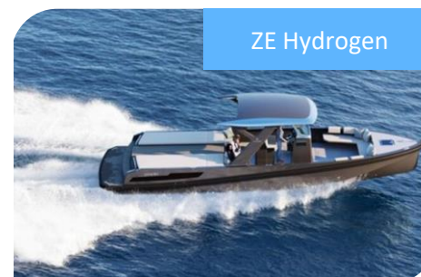
1 * Hynova Marseille - France 1 er Yacht à hydrogène 2*150 kW, 2*44 kWh, REXH2 80 kW, 12 pax
