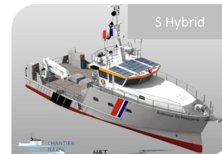
1 * baliseur Saint-Nazaire - France 4*44 kWh
