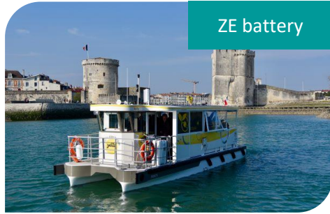
7 * Passeurs La Rochelle, Concarneau, Les Sables - France 2*15 kW, 2*30 kWh, 35 pax
